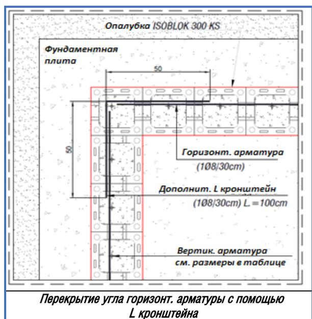
Перекрытие угла горизонт. арматуры с помощью L кронштейна
